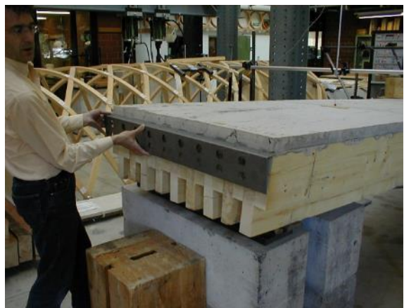
Illustration 4 : Connecteur bois/béton D-dalle®
