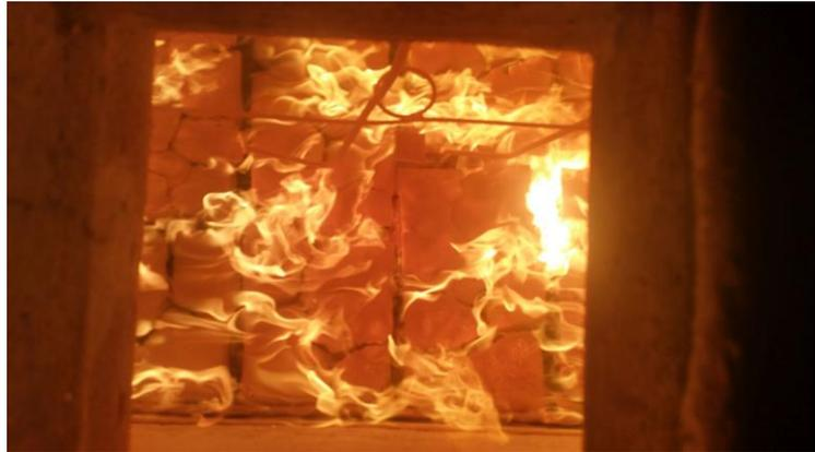
*Hält dem Feuer auch unverputzt mindestens 60 Minuten stand: Eine Holzständerwand mit der Dämmplatte best wood WALL / Top 180 und der Holzfaser-Einblasdämmung best wood FIBRE beim Test in der MFPA Leipzig.
